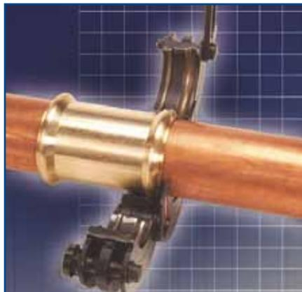
Ouvrez les mâchoires à sertir en appuyant sur les boulons de ressort, dissociez-les et placez-les autour du raccord.
