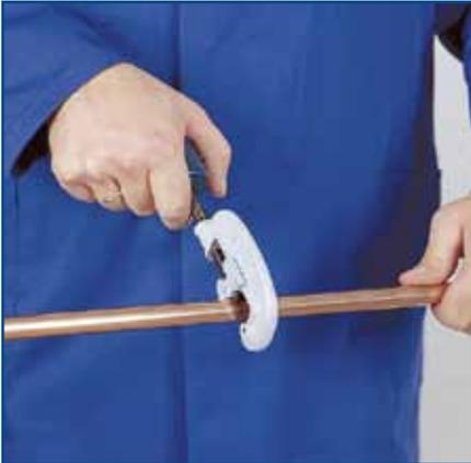
Les TUBES cuivre doivent être, de préférence, coupés à la bonne longueur à angle droit grâce à un coupe-tubes ou à une scie à métaux à dents fines.
