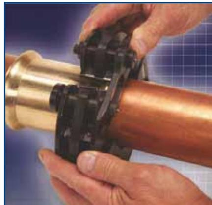
Vérifiez le positionnement entre l'écrou de la mâchoire et la gorge du raccord. La plaque de maintien de la mâchoire doit passer par-dessus l'extrémité du tube de l'assemblage.
