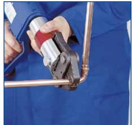
Utilisez des mâchoires à sertir adaptées aux diamètres et placez-les à angle droit aux points de compression sur le raccord. Le cycle de sertissage commence lorsque la machine à sertir est démarrée et s'arrête lorsque les mâchoires à sertir sont totalement fermées. **Attention !** On ne peut obtenir des sertissages sécurisés qu'avec des mâchoires à sertir se déplaçant parfaitement ensemble.
